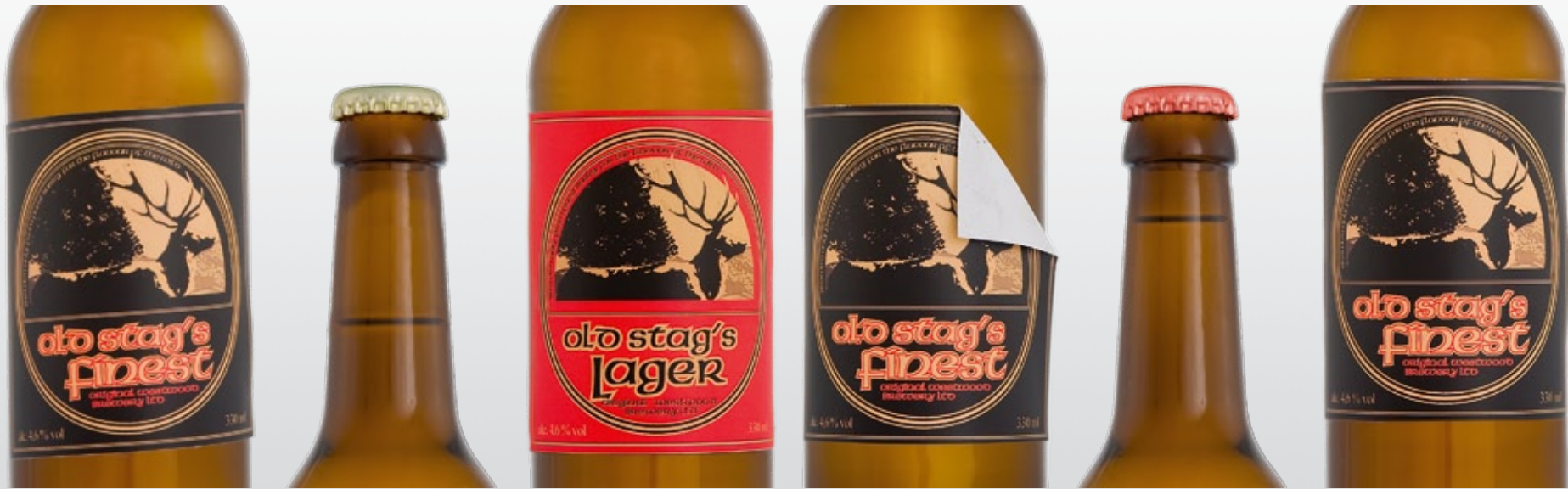
Exemplos típicos de diferentes tipos de falha (rótulo desalinhado, nível de enchimento baixo, rótulo errado, rótulo danificado, tampa errada, posição do rótulo incorreta)
