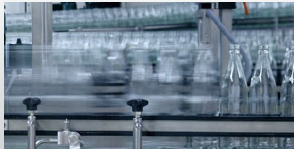
Изменения в потоке бутылок влияют на эффективность линии розлива. Интеллектуальные системы управления конвейером, такие как HEUFT synchron действуют в нужном направлении.
